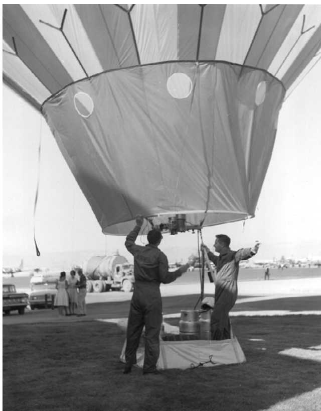
Prototip balona tvrtke »Raven Industries« svoj je prvi let imao 22. listopada 1960. u Bruningu (Nebraska, SAD). Brz i jednostavan »on/off« ventil ubrzo je postao uobičajena oprema
